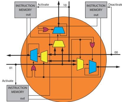
Fig. 5. Data-Driven 1:1 Switch
